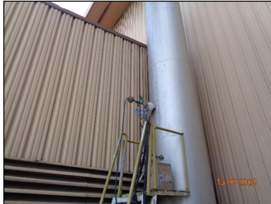
รูปที่ 3.9 การเก็บตัวอย่างคุณภาพอากาศเพื่อตรวจสอบประสิทธิภาพของระบบดักกรองฝุ่น บริเวณ Inlet Dust Collector of Melting Casting Stack
