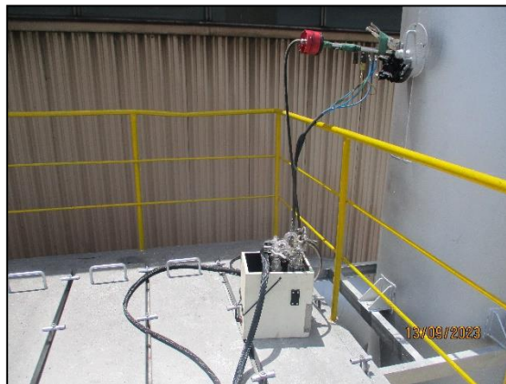
รูปที่ 3.10 การเก็บตัวอย่างคุณภาพอากาศเพื่อตรวจสอบประสิทธิภาพของระบบดักกรองฝุ่น บริเวณ Outlet Dust Collector of Melting Casting Stack
