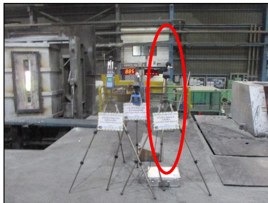
รูปที่ 3.18 การตรวจวัดระดับเสียงในพื้นที่เฉพาะ บริเวณ Casting
