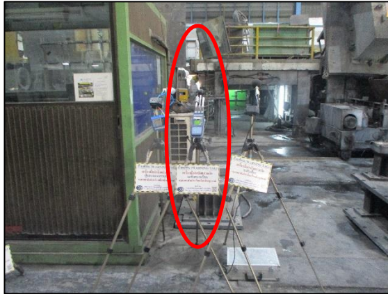
รูปที่ 3.22 การตรวจวัดระดับความร้อนในพื้นที่ทำงาน บริเวณ เตาหลอม (Melting)
