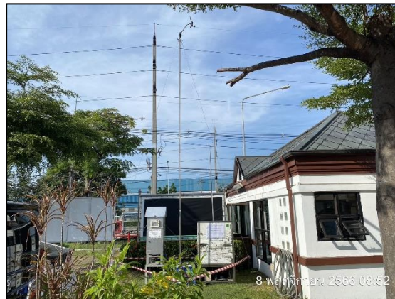
รูปที่ 3.7 การเก็บตัวอย่างคุณภาพอากาศในบรรยากาศท้ายลมมรสุม บริเวณใกล้ทางเข้าออกภายในโรงงานหลอมทองเหลือง
